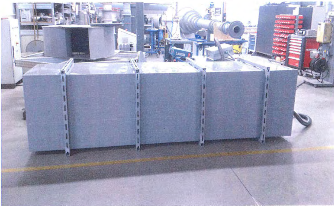
Bild 1: Prüfhilfsmittel Behälter 3000 mm x 800 mm x 800 mm
